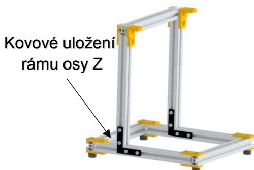
Obr. 2.2 Rám tiskárny.
