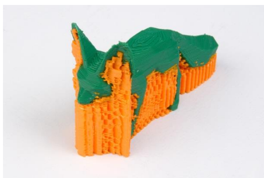
Obrázek 17 - příklad objektu tištěného s podporou (support material)
