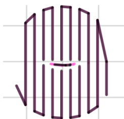
Obrázek 42 - výplň podpory: Honeycomb
