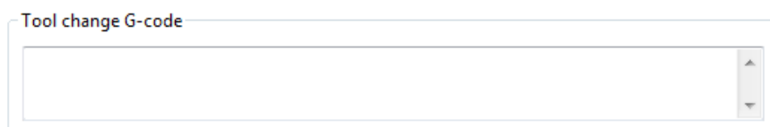
Obrázek 66 - při použití více extruderů, je možné vložit vlastní G-code
