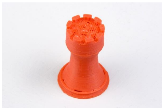
Obrázek 15 - nedostatečný počet horních vrstev
